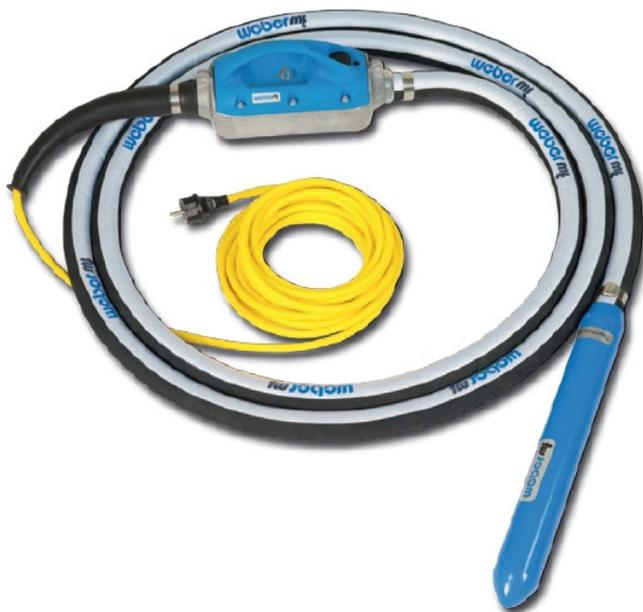
Gli aghi vibranti della serie IVUR sono costituiti da un ago vibrante unito ad un convertitore ad alta frequenza e rappresentano l'attrezzatura ottimale per la compattazione del calcestruzzo.
